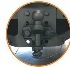
Acoplamiento de la bola de remolque con instalación eléctrica.
